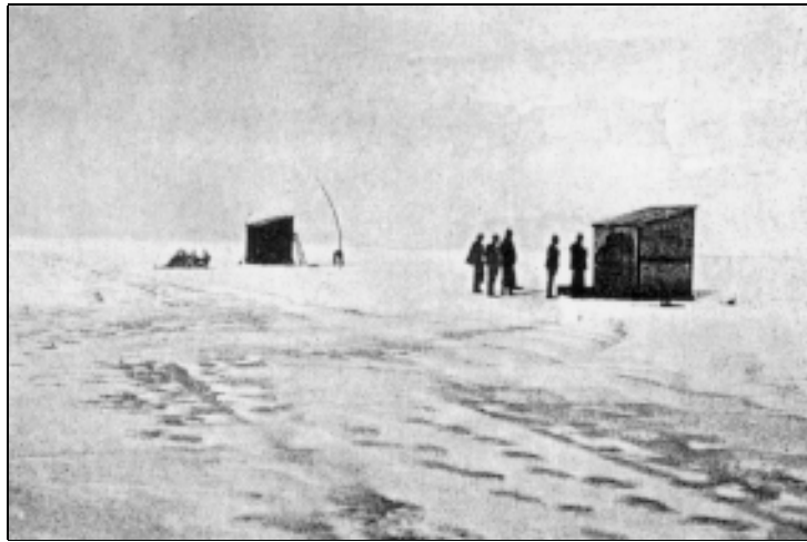
76. ábra. MÉRŐ-ÁLLOMÁS a Balaton jegén. A báró Eötvös Lóránd-féle csavaros mérleggel mértük a föld belsejében a sűrűbb és kevésbé sűrű tömegek elhelyezkedését. Balra a lakósátor, jobbra a műszersátor. (Szerző fényképe.)
